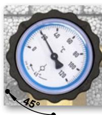
Per lo svuotamento del circuito, escludere la VNR ruotando la manopola con termometro blu di 45° in senso orario, partendo dalla posizione di completa apertura (vedi figura a lato).
