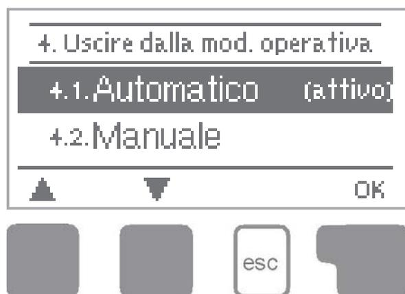
Nel menu “4. Modo funzionamento” la centralina può essere impostata in modalità automatica, off, o in modalità manuale.
