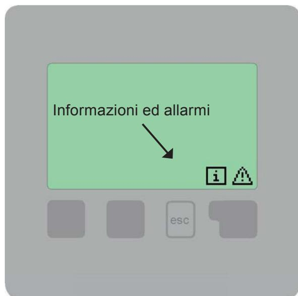
Se la centralina segnala un problema appare il simbolo d'errore nel display. Se l'errore non si presenta a lungo, il simbolo d'errore si modifica in un simbolo d'informazioni.
