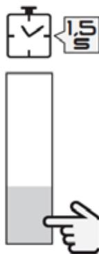
Per entrare nel menù programmazione premere la parte inferiore per 1,5 s.
