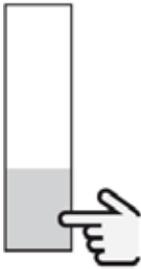
Trovato il parametro da modificare, premere la parte inferiore per 1,5 s e modificare il valore del parametro.
