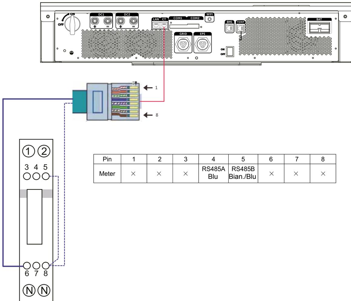
Fig. 2 - Collegamento della comunicazione del Meter monofase
