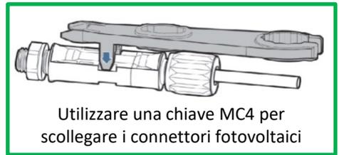
Prima di rimuovere i connettori PV positivo e negativo, assicurarsi che il sezionatore rotativo DC sia in posizione OFF
