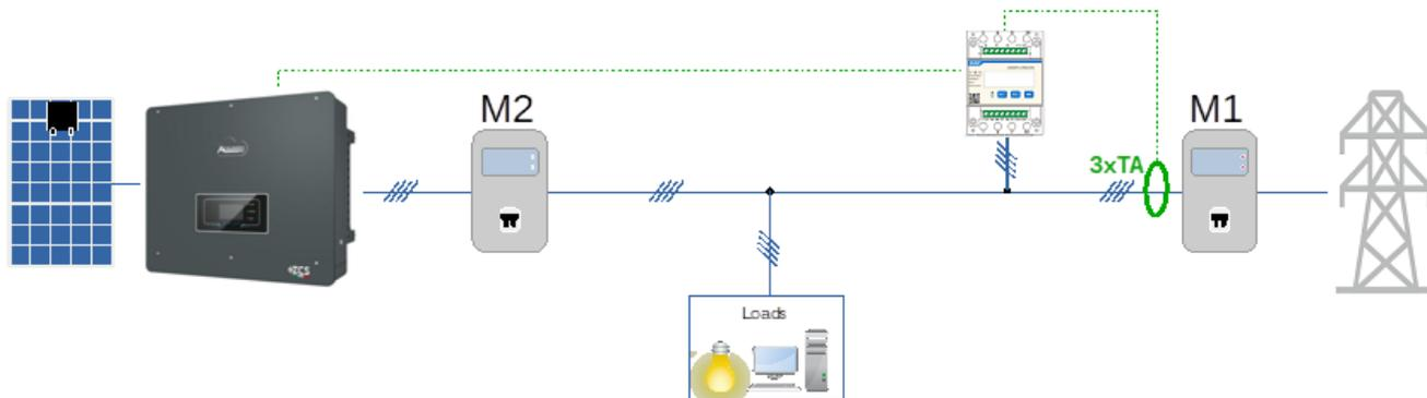
Figura 1 - posizione logica del meter DTSU666
