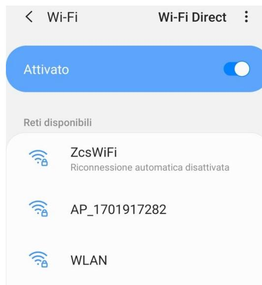
Figura 37 – Disattivazione della riconnessione automatica ad una rete
