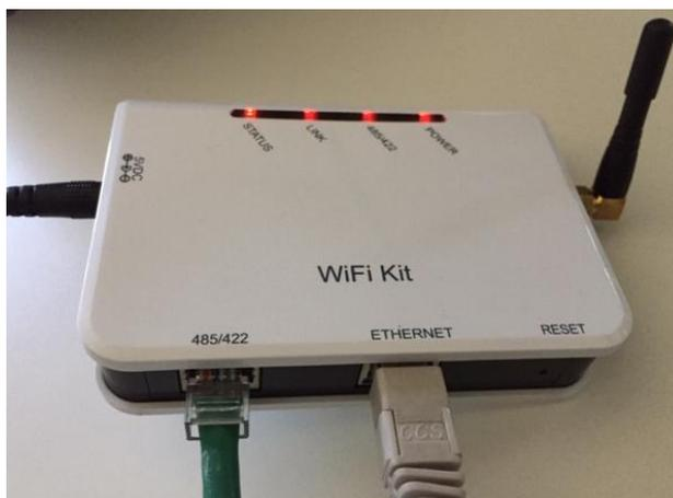
Figura 81 – Cavo ethernet connesso al datalogger
