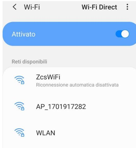
Figura 83 - Disattivazione della riconnessione automatica ad una rete
