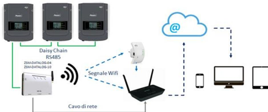
Figura 73 – Schema di connessione del datalogger ZSM-DATALOG-04 / ZSM-DATALOG-10
