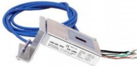
In particolare, per i cavi di segnale, è necessario collegare il sensore, come indicato in tabella sotto, in modalità daisy-chain con i restanti devices del bus RS485.
