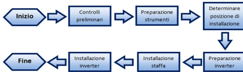
Figura 7 - Passaggi di installazione
