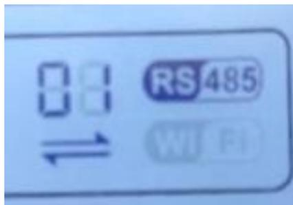
Figura 80 – Simbolo RS485 sul display dell’inverter
