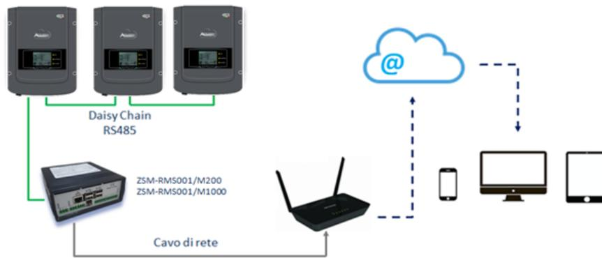
Figura 74 – Schema di funzionamento del datalogger ZSM-RMS001/M200 / ZSM-RMS001/M1000
