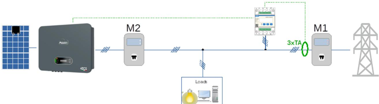
Figura 1 - posizione logica del meter DTSU666
