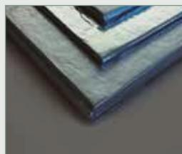
Il VIP U-Vacua™ è costituito da un'esclusiva anima in fibra di vetro racchiusa in una pellicola laminata composta da diversi strati, tra cui nylon, alluminio e uno strato protettivo. La pressione interna è ridotta a un vuoto di 1-20 Pa, riducendo così al minimo la conducibilità termica.
