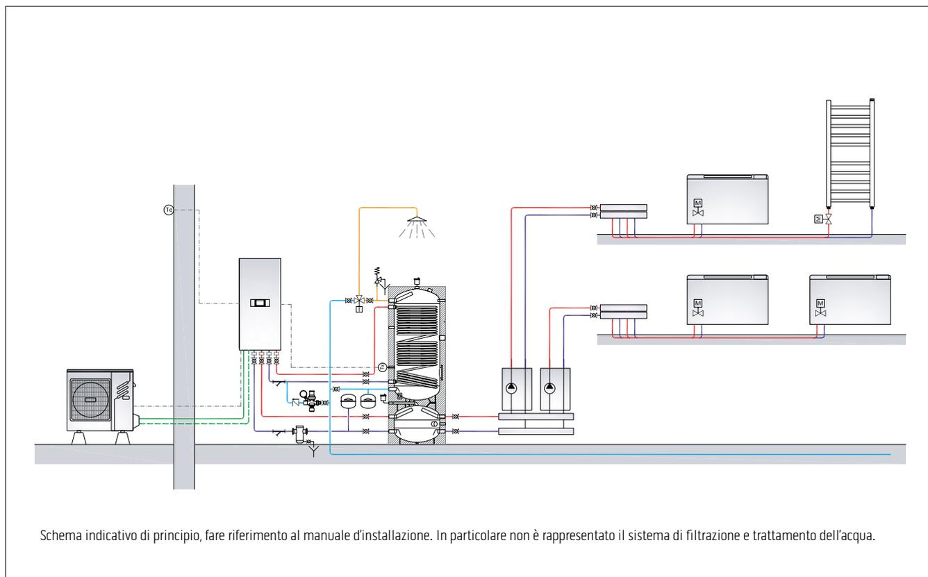
Pompa di calore SHERPA AQUADUE TOWER S2/S3 (riscaldamento e condizionamento; produzione di ACS ad alta temperatura); terminali ventilradiatori Bi2 SLR; esempio di schema a due zone con semplice collettore e accumulo inerziale (usato come separatore idraulico) per l'impianto di climatizzazione.
