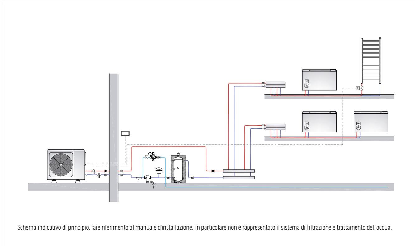
Pompa di calore SHERPA MONOBLOC S2 E (riscaldamento e condizionamento; produzione di ACS) terminali ventilradiator Bi2 SLR, integrazione sanitario con solare termico e accumulo inerziale integrato (usato come separatore idraulico) per l'impianto di climatizzazione.
