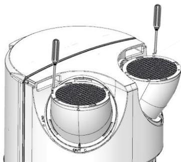
① Svitare le viti di bloccaggio delle griglie per montaggio ambiente..
