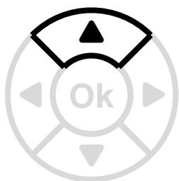
Per accedere al menu di test dell'installazione, premere simultaneamente il tasto MENU e la freccia SU per almeno 5 secondi.
