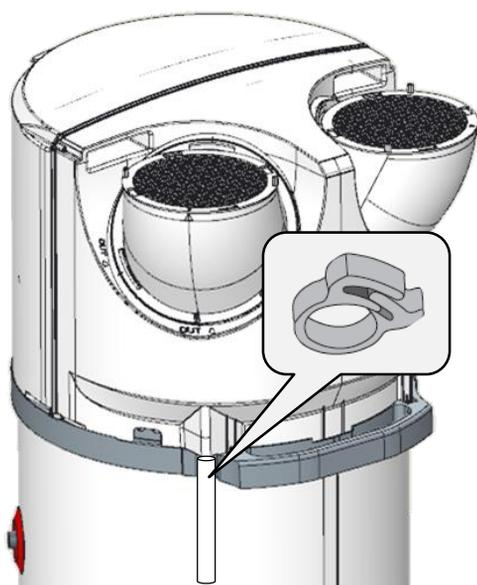
1. Inserire il tubo di scarico della condensa sul collettore di scarico nella parte posteriore destra del prodotto.
