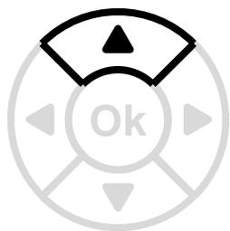
Per accedere alla configurazione dell'installazione, premere simultaneamente il tasto MENU e la freccia SU per almeno 5 secondi.
