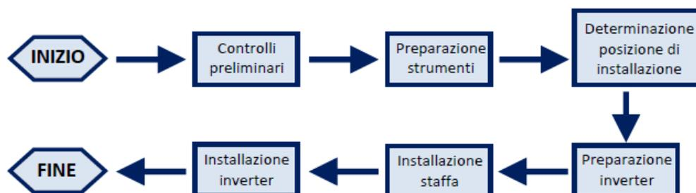
Figura 3 - Processo installazione
