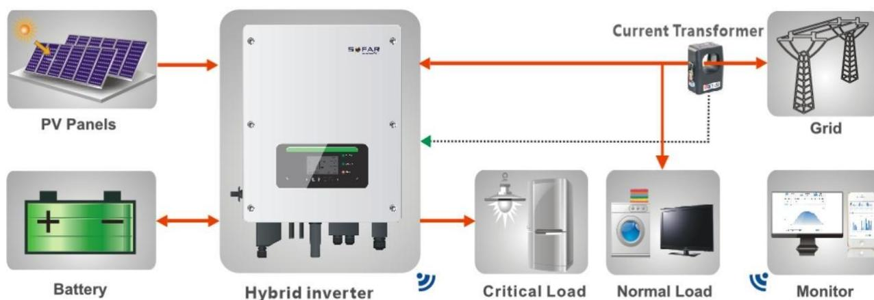
Figura 1 - Diagramma schematico di un impianto con inverter ibrido HYD 10-20KTL-3PH
