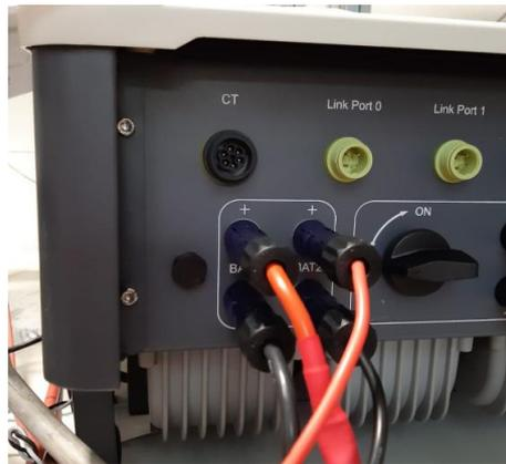
Figura 18 - Connessione potenza DC lato inverter con due ingressi batteria popolati
