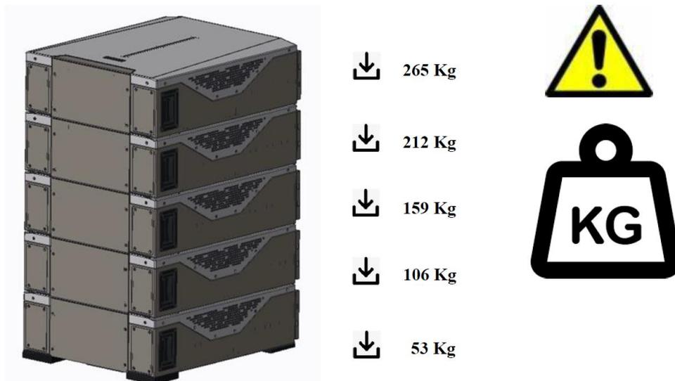
**Figura 3 - Verifica carico ammissibile solaio**
