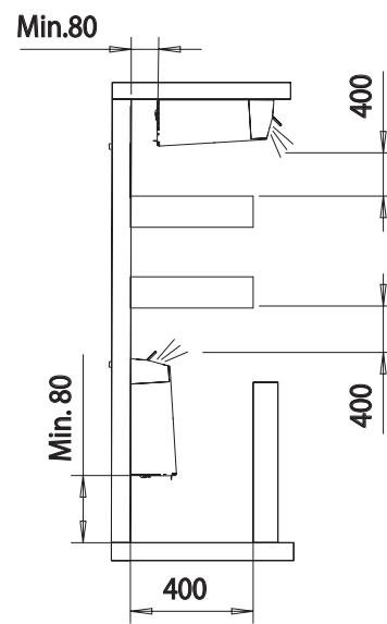
El aparato debe ser instalado en una posición que permita realizar fácilmente las operaciones de mantenimiento ordinario (limpieza del filtro) y extraordinario, así como el acceso a las válvulas de purga de aire (batería y panel), que pueden ser alcanzadas a través de la rejilla superior (en el lado de las conexiones).
