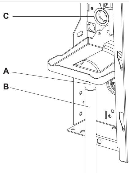
**Montaje del dispositivo de descarga de la condensación en la versión vertical**
