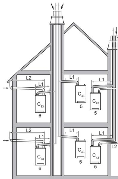
Il tubo orizzontale per i fumi della combustione DEVE essere installato 3° di caduta più in basso verso la caldaia (50 mm per metro) e DEVE essere sostenuto con almeno 1 staffa per ogni metro di lunghezza. La posizione migliore consigliata per la staffa è nel punto immediatamente prima del giunto.
