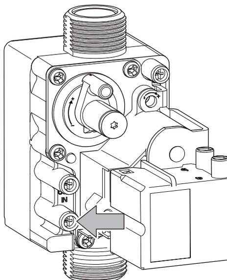
**Risultato:** L'alimentazione del gas deve spurgare l'aria.
