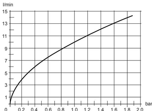
Il flusso minimo per la funzione acqua calda sanitaria è 1,5 l/minuto. La pressione minima è 0,1 bar. Un flusso basso (<5 l/min) riduce il comfort. Accertarsi di impostare un setpoint sufficientemente elevato.
