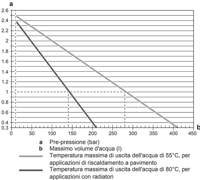
**Esempio in caso di applicazione di riscaldamento a pavimento: volume massimo di acqua e pre-pessione del vaso di espansione nel caso di 55°C**
