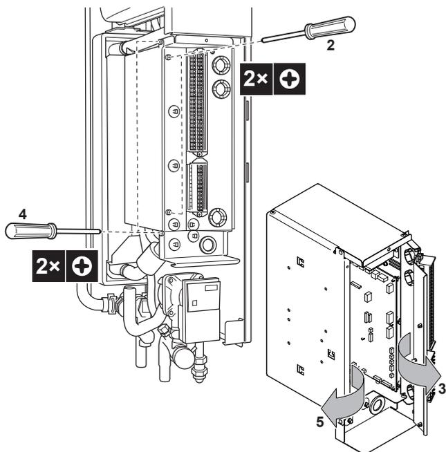
Una volta installata la caldaia, se fosse necessario accedere al quadro elettrico, seguire la procedura descritta nel seguito.
