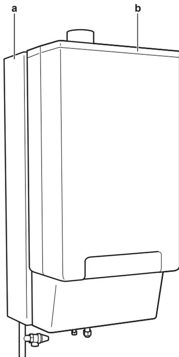
a Modulo della pompa di calore
