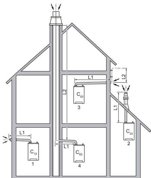
Il tubo orizzontale per i fumi della combustione DEVE essere installato 3° di caduta più in basso verso la caldaia (50 mm per metro) e DEVE essere sostenuto con almeno 1 staffa per ogni metro di lunghezza. La posizione migliore consigliata per la staffa è nel punto immediatamente prima del giunto.
