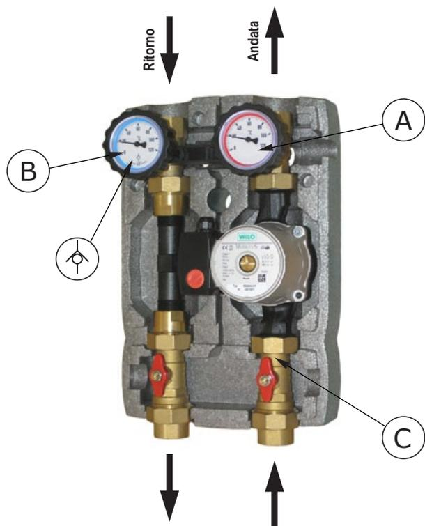
I moduli idraulici MODVLVS Energy sono destinati alla contabilizzazione dell'energia in impianti di riscaldamento e raffrescamento centralizzati. Questi moduli, grazie alla presenza di due organi di intercettazione sul ramo di ritorno, consentono un agevole montaggio del contabilizzatore di energia. Il secondo sensore di temperatura viene inserito direttamente nella valvola di isolamento nel ramo di mandata, senza l'ausilio di adattatori o pozzetti.
