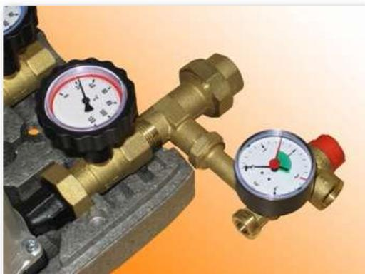
Connessione con gruppo di sicurezza (codice 03647D-3C-4SET)\*, per compensare le eventuali sovrappressioni nell'impianto. Estremità inferiore 3/4" maschio per collegamento con tubo flessibile o kit di scarico codice 103647P.
