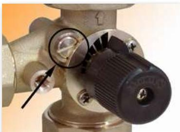
Il by-pass integrato nella valvola miscelatrice a 3 vie assicura un ricircolo dell'acqua all'interno dell'impianto anche quando la valvola miscelatrice è completamente aperta. Mediante il by-pass può essere impostata una percentuale fissa di miscelazione, nel caso in cui la portata attraverso la valvola miscelatrice non sia sufficiente.
