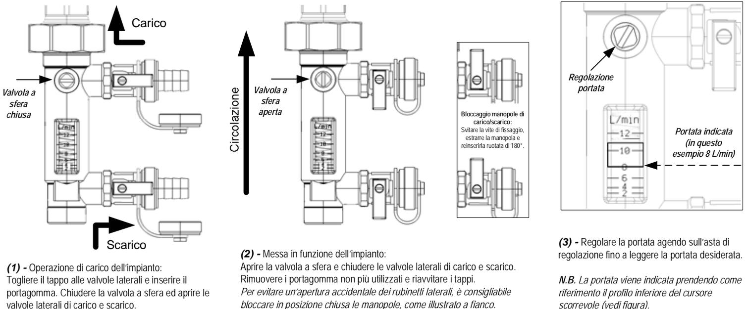
(1) - Operazione di carico dell'impianto:
