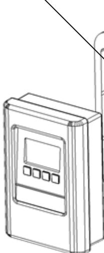
Uscita cablaggi centralina (sonde, alimentazione, circolatore)
