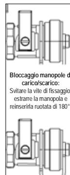
Bloccaggio manopole di carico/scarico: Svitare la vite di fissaggio, estrarre la manopola e reinserirla ruotata di 180°.
