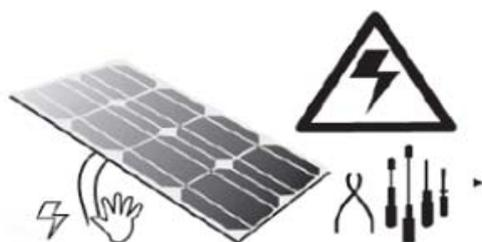
Utilizzare strumenti isolati per i collegamenti elettrici
