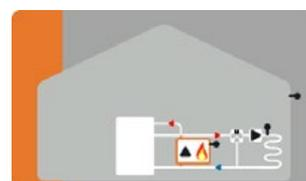
Serbatoio combinato oppure serbatoio buffer con circuito di riscaldamento miscelato con le funzioni aggiuntive bruciatore e pompa del boiler
