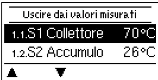
Visualizzazione delle temperature misurate correnti.
