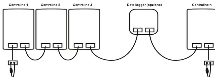
1. Le centraline sono collegate in serie con il cavo CAN bus.
