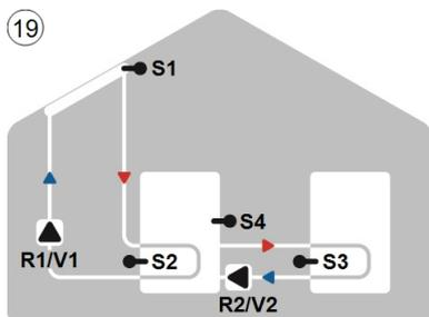
Solare con trasferimento serbatoio
