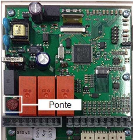
Se la tensione di alimentazione è attiva e la centralina non funziona ancora o non appare nulla nel display, il fusibile interno potrebbe essere difettoso. In questo caso, aprire il dispositivo come descritto nella sezione C, rimuovere il vecchio fusibile e controllarlo.
