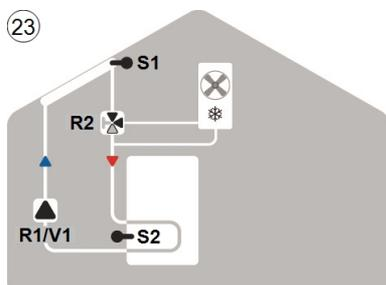
Solare con raffreddamento 1 (raffreddamento del collettore)
