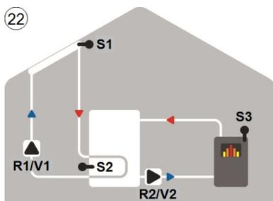
Solare con boiler a combustibile solido
