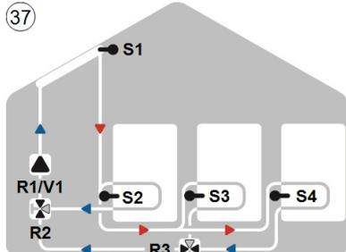
Solare con 3 serbatoi e 3 valvole di commutazione
