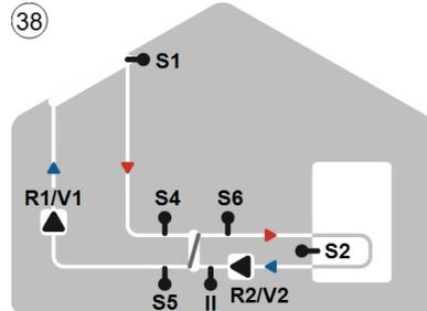
Solare con scambiatore di calore
