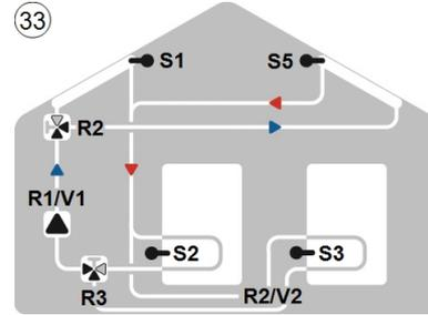
Solare con 2 superfici di collettori, 2 serbatoi e 2 valvole
