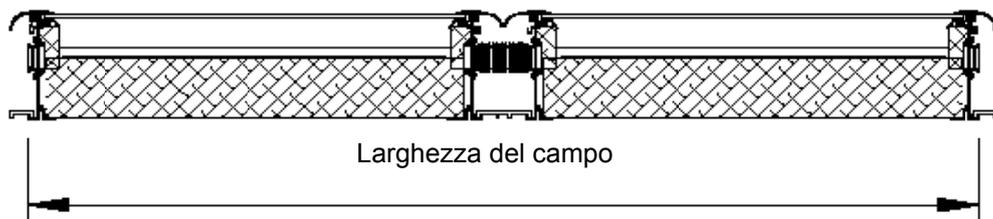
I collettori montati in fila orizzontale vengono collegati tra loro sempre tramite compensatori in acciaio inox posti al di sopra dei collegamenti tra i tubi collettori. (vedi foto)
