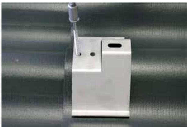
Praticare i fori per le viti di fissaggio con un trapano con punta 8mm
