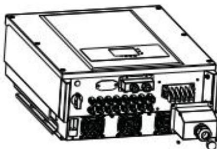
Figura 28- Connessione dei cavi AC di uscita (1)
