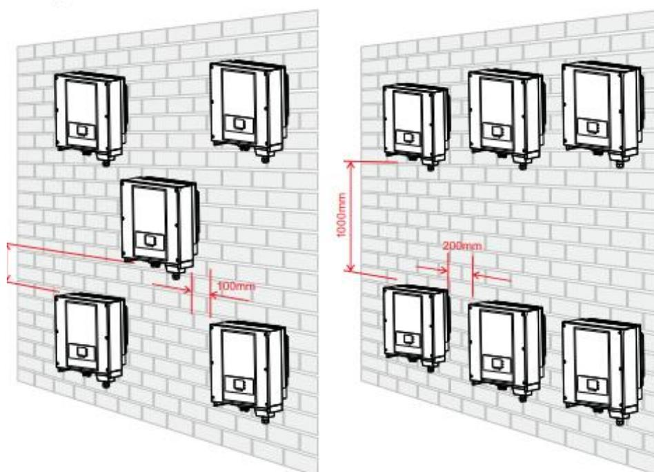
Figura 13 – Requisiti di installazione per più inverter
