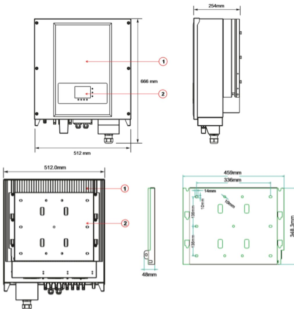
Figura 5 - Vista frontale, laterale e posteriore dell'inverter e della staffa
