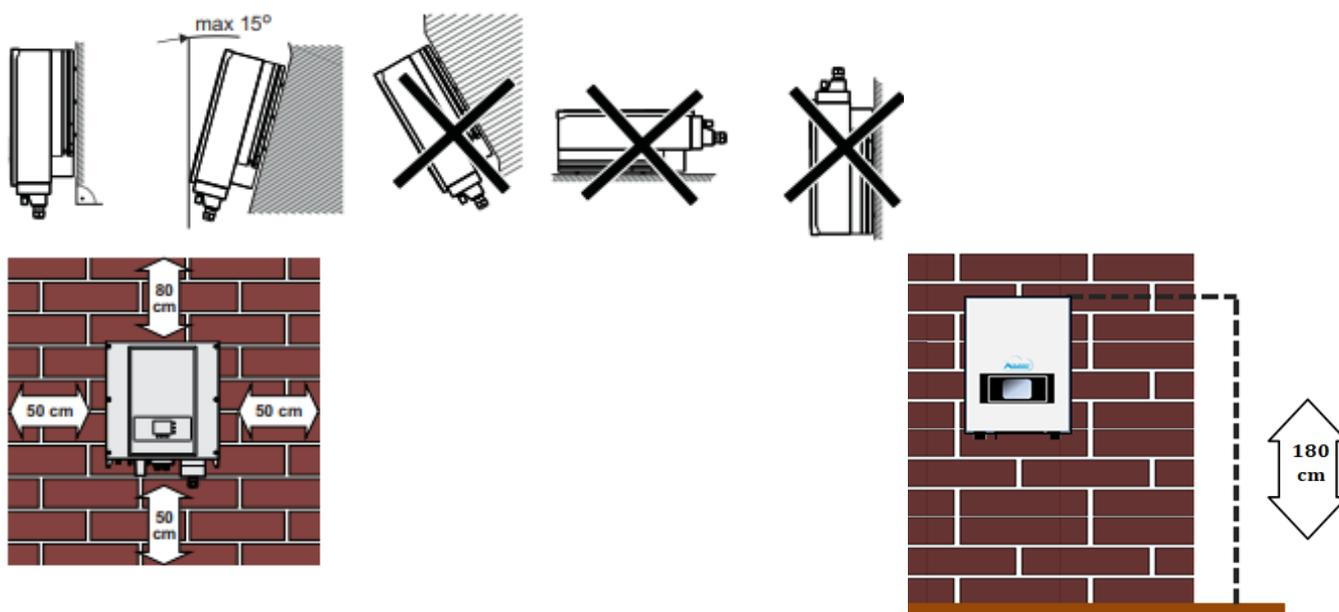
Figura 12 – Requisiti di installazione per un singolo inverter
