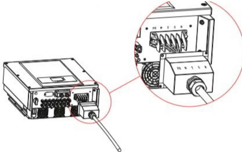
Figura 30 - Connessione dei cavi AC di uscita (3)
