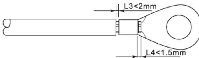
Figura 20 - Preparazione del cavo di terra (2)
