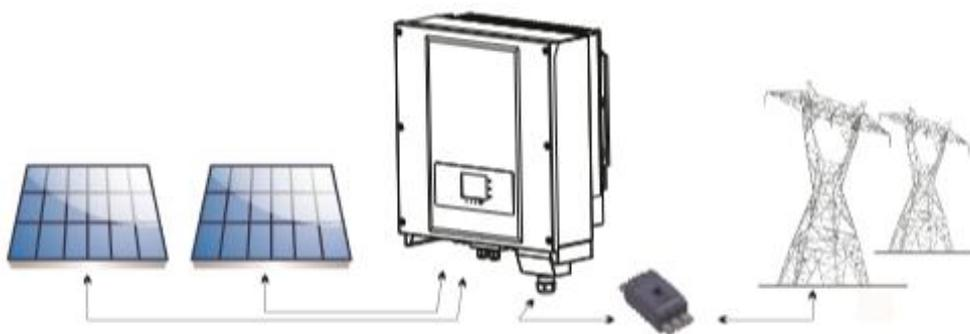
Figura 2 - Impianto fotovoltaico connesso in rete
