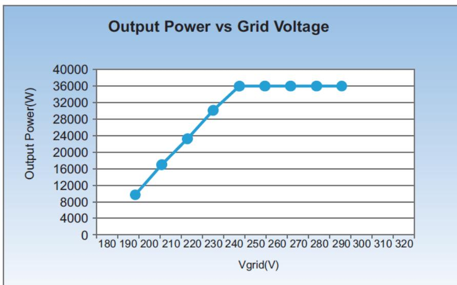
Figura 10 - Curva di derating della tensione in uscita per un inverter Azzurro ZCS della famiglia 20K-33 KTL
