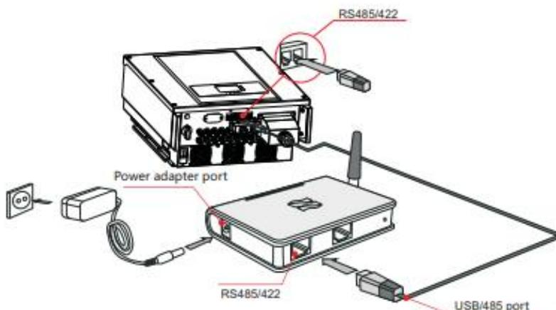
Se l'impianto è costituito da più inverter, collegare ciascuno di essi in daisy chain utilizzando un cavo di comunicazione RS485. Impostare poi l'indirizzo RS485 in base a quanto riportato nel capitolo 6.3 (fare riferimento alla figura seguente).
