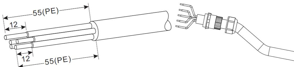
Figura 29 - Connessione dei cavi AC di uscita (2)
