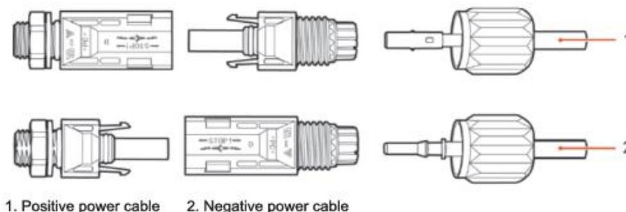
Figura 24 - Connessione dei cavi di potenza DC in ingresso (2)
