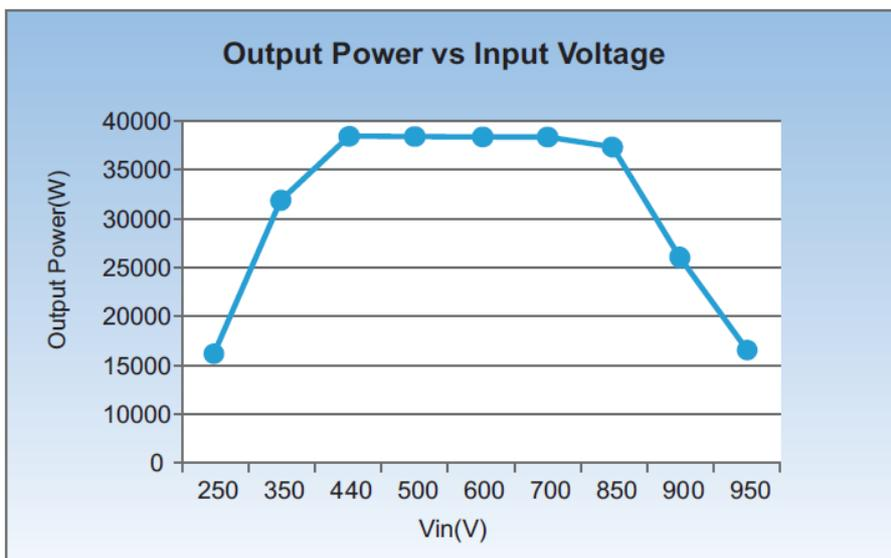
Figura 9 - Curva di derating della tensione in ingresso per un inverter Azzurro ZCS della famiglia 20K-33 KTL
