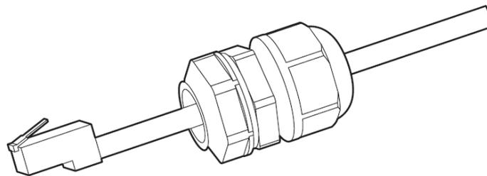
Figura 34 - Montaggio del connettore di comunicazione
