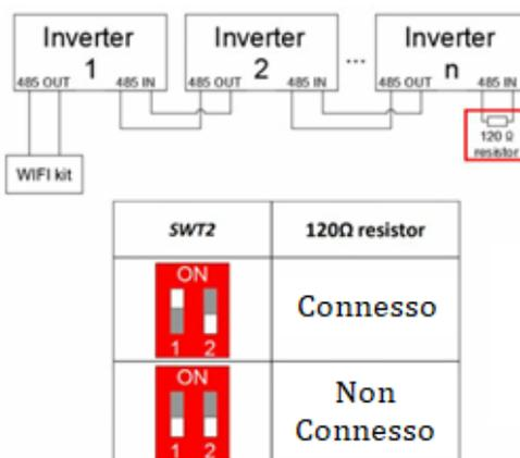
Se l'impianto è costituito da un solo inverter, usare un cavo di comunicazione con connettori impermeabili RJ45, scegliere una delle due porte RS485 ed impostare l'indirizzo RS485 in base a quanto riportato nel capitolo 6.3.
