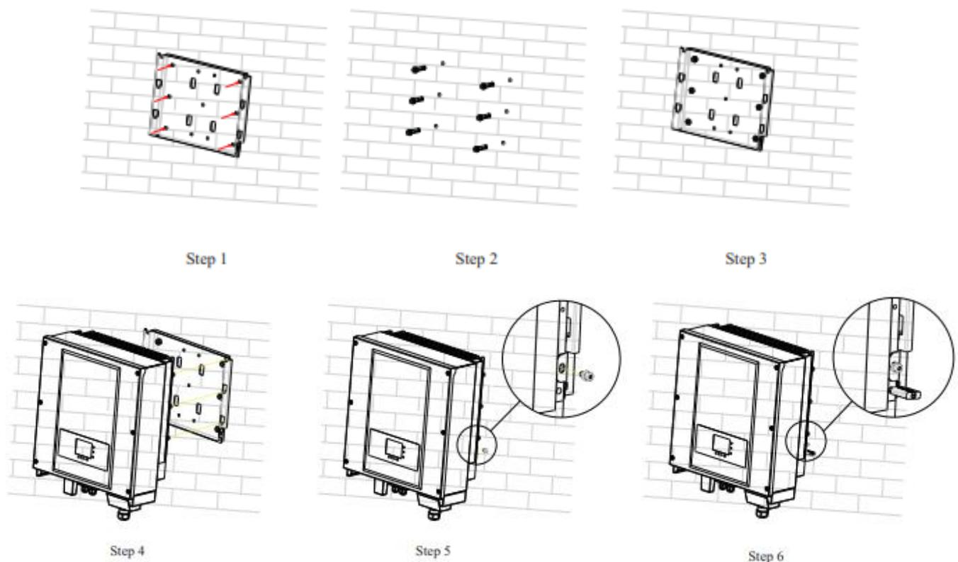
Figura 16 - Passaggi per l'installazione a parete dell'inverter
