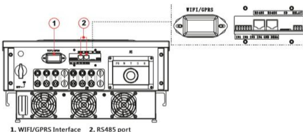
Figura 31 - Vista inferior dell'inverter 10-20K TL
