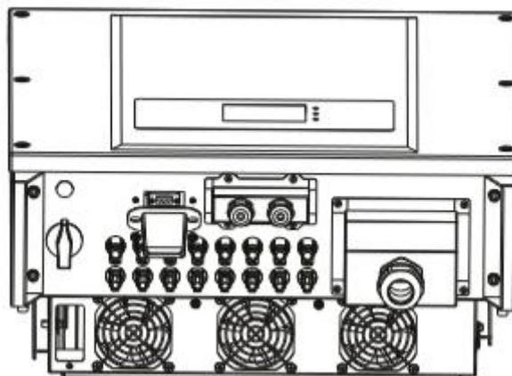
3) Fissare il modulo Wifi esterno utilizzando le due viti in dotazione.
