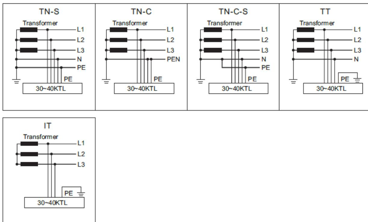
Figura 3 - Schemi elettrici dei tipi di rete su cui poter installare gli inverter 20K-33KTL
