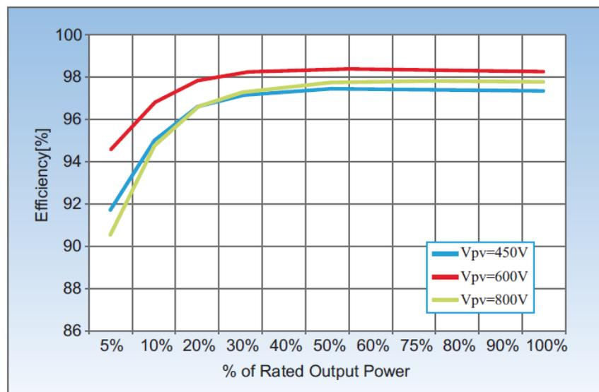
Figura 8 – Curva di efficienza per un inverter Azzurro ZCS della famiglia 20K-33 KTL
