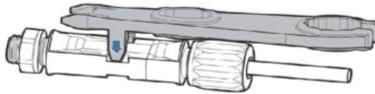
Figura 26- Rimozione del connettore DC
