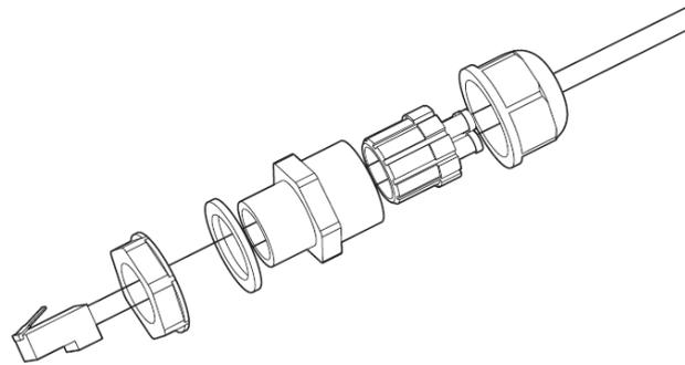
Figura 33 - Montaggio del connettore di comunicazione
