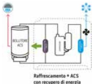
In funzionamento estivo il calore sottratto all'aria interna anziché essere smaltito esternamente viene trasferito al boiler per la produzione di ACS gratuita.
