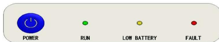
Nel caso di batterie **WeCo**, premere il tasto POWER di ciascuna batteria per 1 secondo, il led RUN si accenderà ed il contattore interno si chiuderà in automatico.
