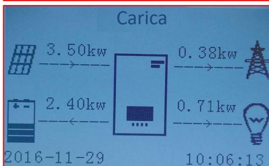
A batteria completamente carica, o quando la potenza di carica viene limitata (per preservare l’integrità della batteria), la potenza in eccesso verrà esportata in rete.
