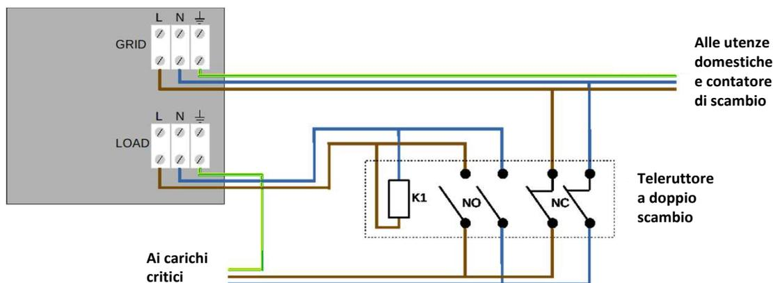
**NOTA:** Per le condizioni sopra descritte, in caso di black out elettrico, la parte di impianto alimentato dalla porta LOAD dell'inverter si comporta come un sistema IT.
