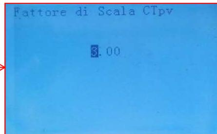
**NOTA:** Il fattore di scala CTpv è il coefficiente moltiplicativo del valore di potenza letto dalla sonda CTpv sulla fase in cui è installata.
