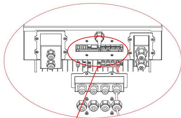
Riposizionare il coperchio e fissarlo con le 4 viti; serrare infine i pressacavo.
