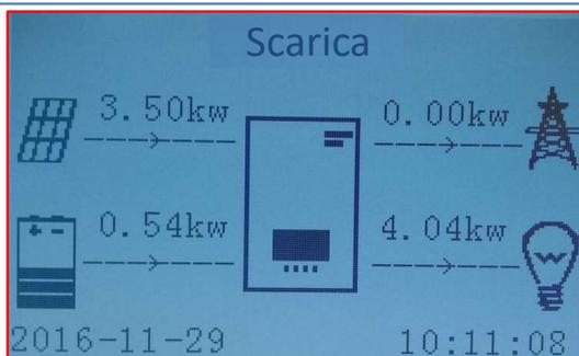
Quando la potenza dell’impianto fotovoltaico sarà minore di quella richiesta dai carichi il sistema utilizzerà l’energia stoccata nella batteria per alimentare i carichi di casa.
