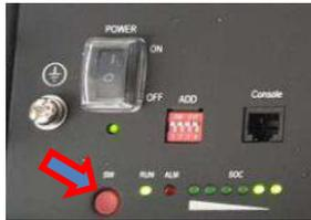
Premere per un secondo il pulsante rosso SW di **una sola** batteria, il contattore interno si chiuderà in automatico.
