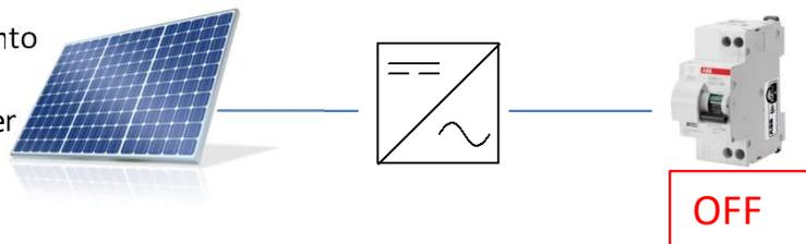
Assicurarsi di avere un carico in casa di almeno 200 W, per averne certezza misurare con una pinza amperometrica la corrente presente sulla fase sotto al contatore di scambio. La corrente sarà entrante dalla rete verso l'utenza.
