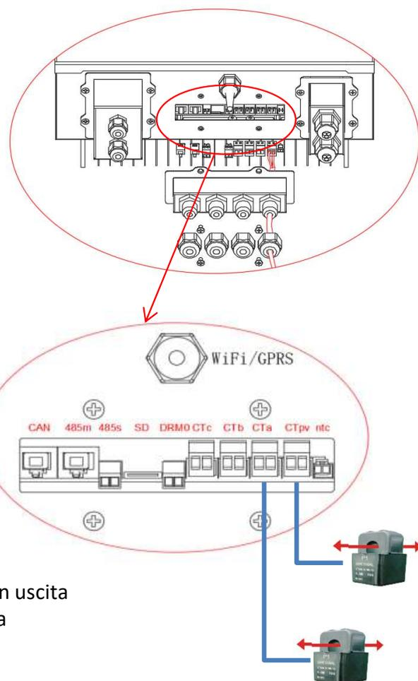
Posizionare le sonde di corrente (CT) in maniera corretta:
