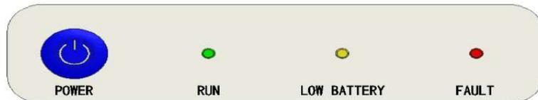
Nel caso di batterie **WeCo**, premere il tasto POWER di ciascuna batteria per 1 secondo, il led RUN si accenderà ed il contattore interno si chiuderà in automatico.
