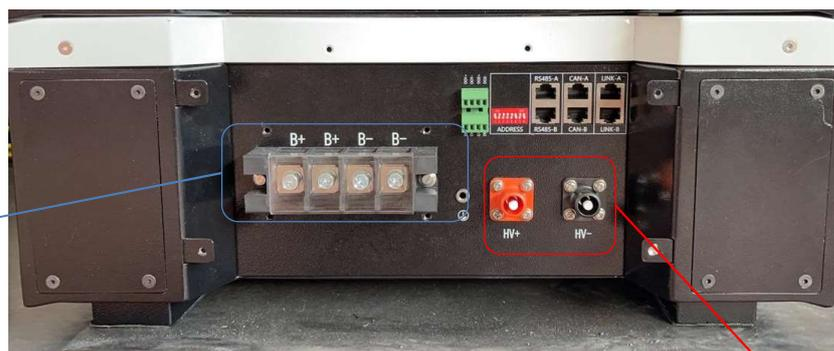
Sezione per il collegamento in bassa tensione (LV)
