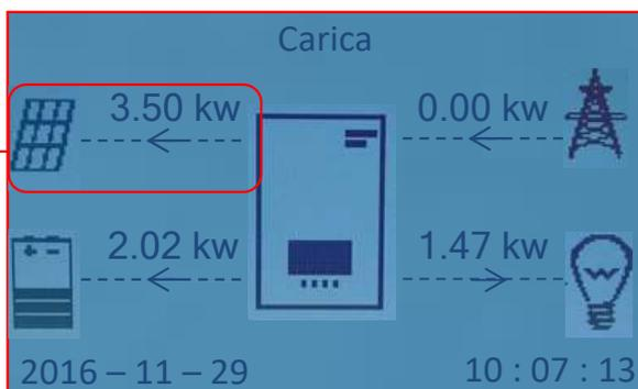
10) Confrontare il valore di potenza fotovoltaica mostrato a display dell'accumulo con quello indicato dall'inverter fotovoltaico verificando che siano pressoché uguali.
