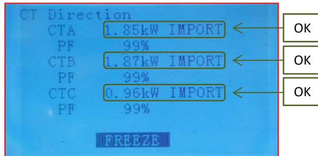
Se ciascuna sonda è stata posta correttamente sulla sua fase di riferimento il valore di **PF** (Sfasamento fra tensione e corrente) sarà superiore al 90% circa su tutte e tre le fasi.
