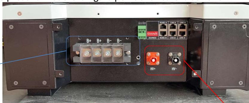
**Attenzione:** Per il collegamento delle batterie 5k3 con inverter inverter monofase è obbligatorio utilizzare la sola sezione in bassa tensione. Non utilizzare la sezione in alta tensione onde evitare danneggiamenti di batterie o inverter
