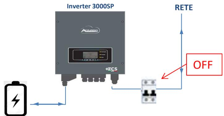
Assicurarsi che in nessuna fase sia presente produzione da parte dell'impianto fotovoltaico, aprire quindi l'interruttore di protezione AC dedicato all'inverter fotovoltaico in modo da essere certi che non sia in produzione.
