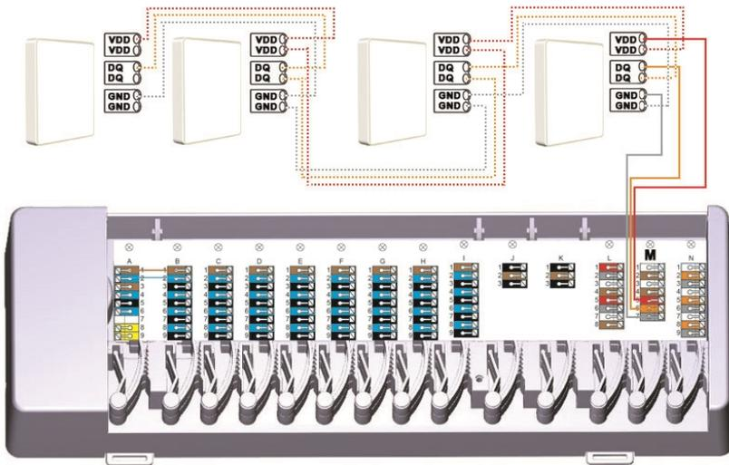
**Esempio 2:** Struttura ad albero. Diverse stacchi sulla linea collegano la linea principale ai singoli sensori.
