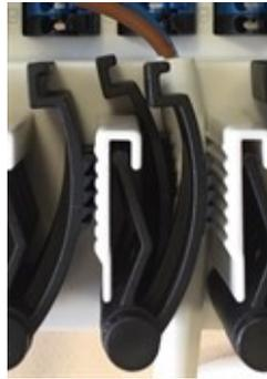
Le fascette di rinforzo sono adatte per cavi flessibili con diametro della guaina da 5mm a 8mm, utilizzando prima quelle in basso (vedi immagine). Controllare che i cavi siano posizionati in modo sicuro. Fili massicci, spessi o sottili devono essere tenuti fermamente e fissati nell'apposito alloggiamento.
