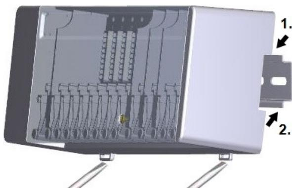
Fissare il binario DIN in orizzontale sulla parete usando delle viti.
